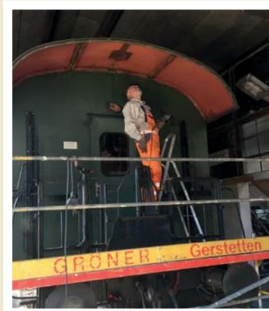
Der Frost im Winter 2016/2017 hatte einen unserer Zweiachsplattformwagen (Spantenwagen 19 054) einseitig entkleidet. Wo die Farbe schon mal ganz runter war, haben wir im unteren Bereich zeitaufwendige Korrosionsschutzarbeiten ausgeführt. Der Wagen wurde in der Folge „außenrum“ saniert und stand erst zu den Fahrten anlässlich des Bahnhofsfests im September wieder zur Verfügung.
