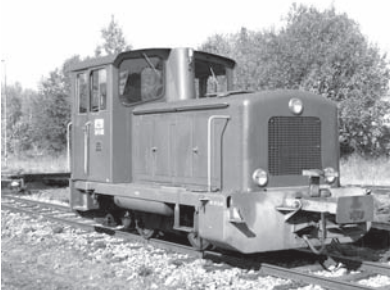
Die „Neue“ im herbstlichen Sonnenlicht des Bahnhofes Amstetten: Ungewohnt erscheint die Kombination aus automatischer GF-Kupplung und herabgeklapptem Mittelpuffer.
