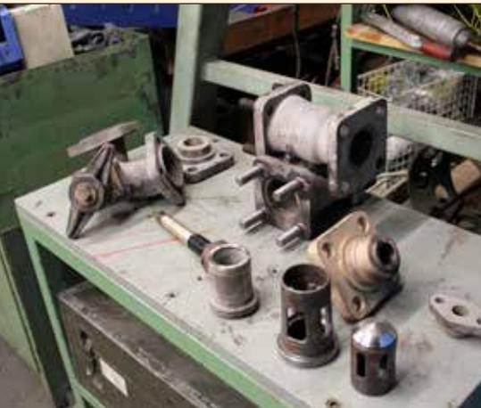
▲ Eines der beiden Speiseventile in Einzelteilen. Sandgestrahlt, Stiftschrauben erneuert und die Dichtflächen nachgearbeitet. Der nächste Schritt ist der Zusammenbau und die Lackierung.
