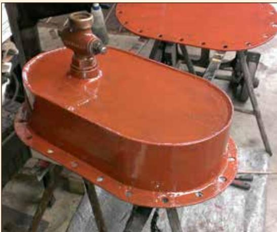
▲ *Diese Deckel wurden abgeschliffen und neu grundiert. Sie gehören zum Wasserkasten unter dem Kohlekasten, der auch saniert werden muss.*
