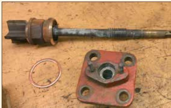
▲ Das zerlegte Dampfheizungsumstellventil in Einzelteilen.
