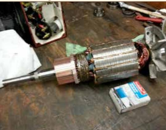
Auch die Lichtmaschine befindet sich in Eigenleistung in Aufarbeitung, im Anschluss sind Luft- und Speisepumpe zur Instandsetzung vorgesehen.
