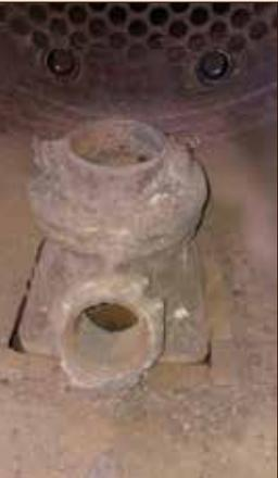
▲ Der Blasrohrkopf ist leider stark korrodiert, er muss neu beschafft oder hergestellt werden.
