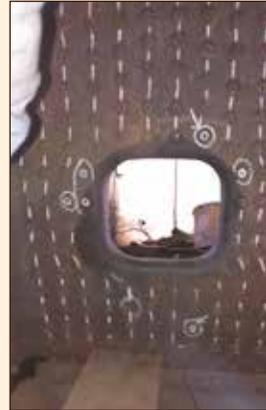
Ein Blick aus der Feuerbüchse Richtung ▲ Führerhaus mit dem Feuerloch. Auch hier sind die Stehbolzen markiert wie oben beschrieben.
