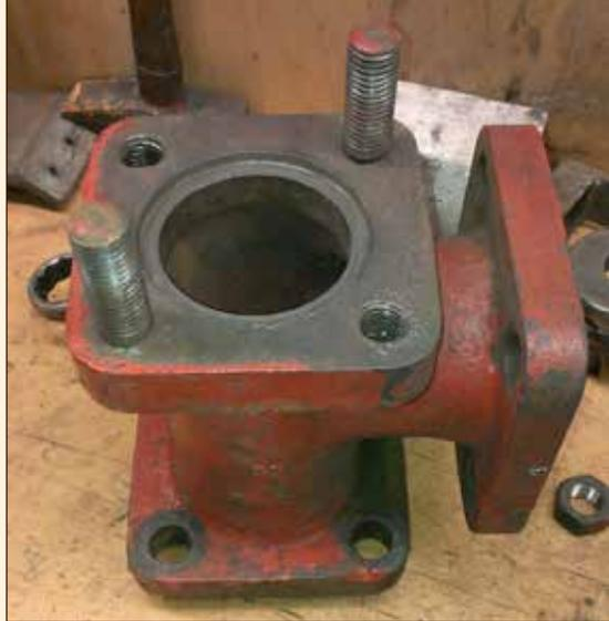
▲ So eine Lok besteht aus vielen Einzelteilen, manche davon auch durchaus handlich: Das abgebaute Gehäuse für die Umstellung der Dampfheizung nach vorne oder hinten.
