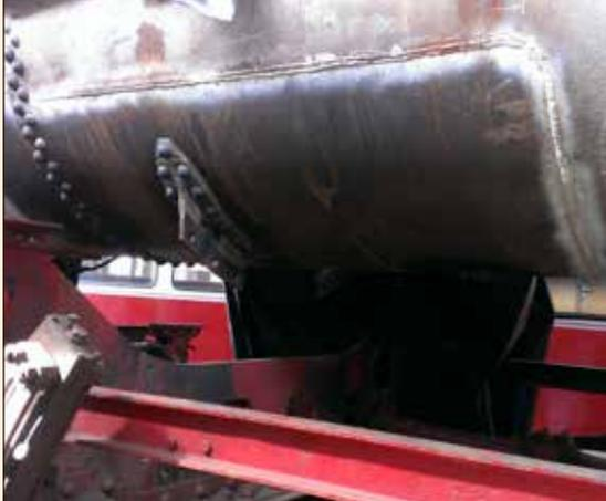
▲ *Der eingeschweißte Kesselbauchflicken mit neu angeieteten Pendelblechhalter und neuer Rundnietnaht.*
